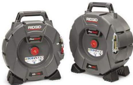
RIDGID® FlexShaft Trommeln verwenden spezielle Kettenschleudern, die an einer flexiblen Spirale befestigt sind und mit hoher Geschwindigkeit gedreht werden. Angetrieben wird die Einheit von einem Akkuschauber mit Rutschkupplung (nicht im Lieferumfang), der an der Antriebswelle in der Mitte befestigt wird. Da die Spirale in der robusten Nylon-Ummantelung rotiert, die in einer vollständig geschlossenen Trommel untergebracht ist, entsteht weniger Schmutz am Einsatzort.
